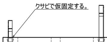
脚柱部の前後の面間寸法を確認します。(標準品は 2095mm) 面間寸法が測定しにくい場合は、内側の縁間寸法を斜めに計測し、下の図の寸法であることを確認してください。許容誤差は±3mmです。
